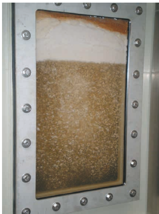
Abb. 8: Optische Kontrollmöglichkeit der Flockengröße und der Luftbläschen
