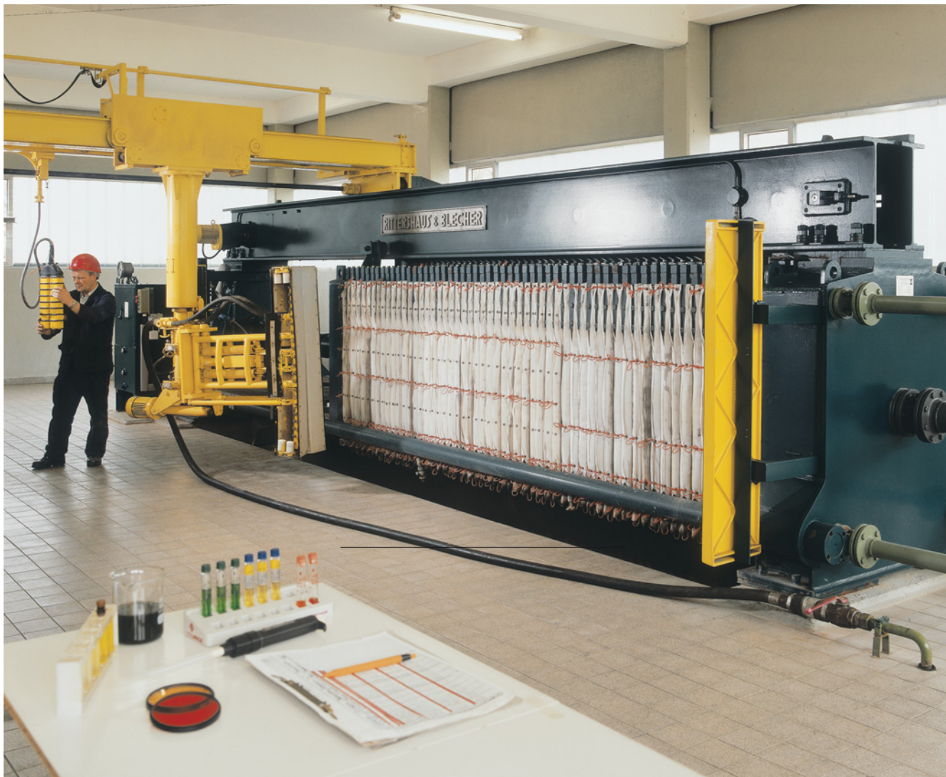
Abb. 8: Schlammwässerung mittels Kammerfilterpresse
