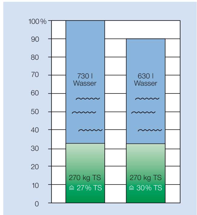
Abb. 5: Darstellung der Schlammvolumenreduzierung durch TS-Verbesserung
