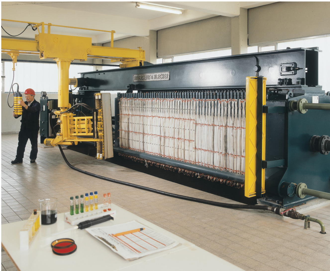
Fig. 8: Deshydratation de boues avec un filtre-presse à chambres
