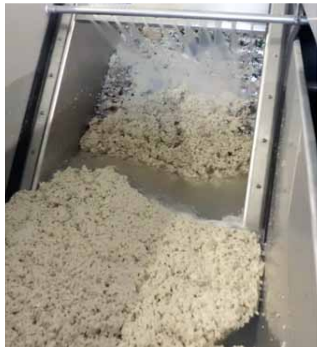
Abb. 4: Mechanische Reinigung eines Abwassers aus der Wurstproduktion
