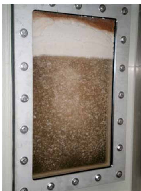
Abb. 8: Kontrolle der Flockengröße und der Luftbläschen
