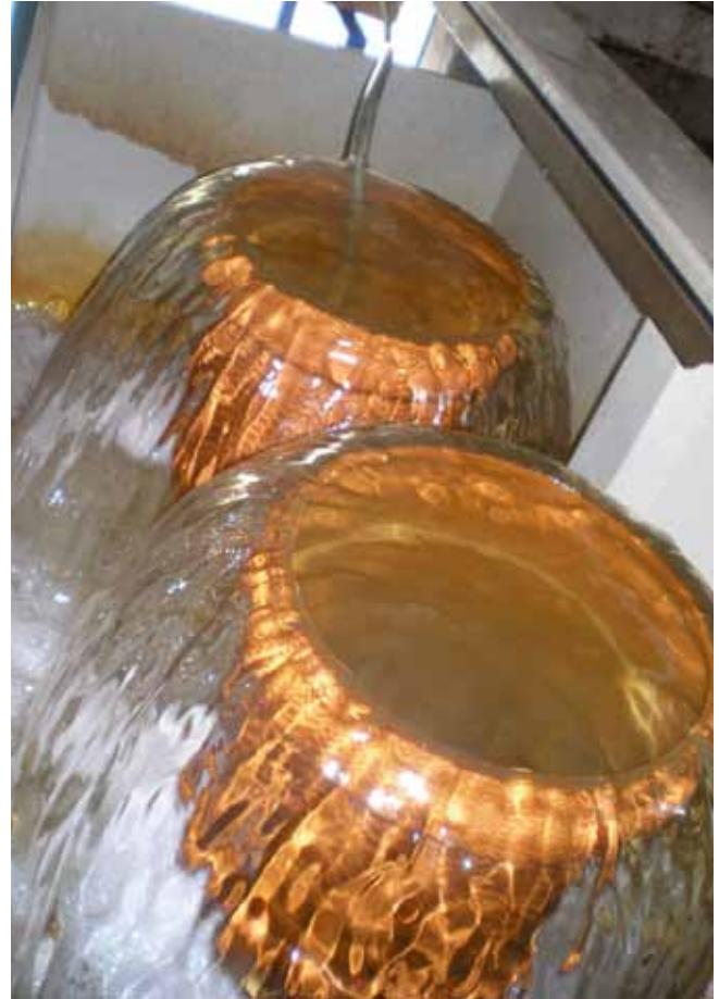
Abb. 11: Ablauf der Flotationsanlage bei optimaler Chemikalieneinstellung
