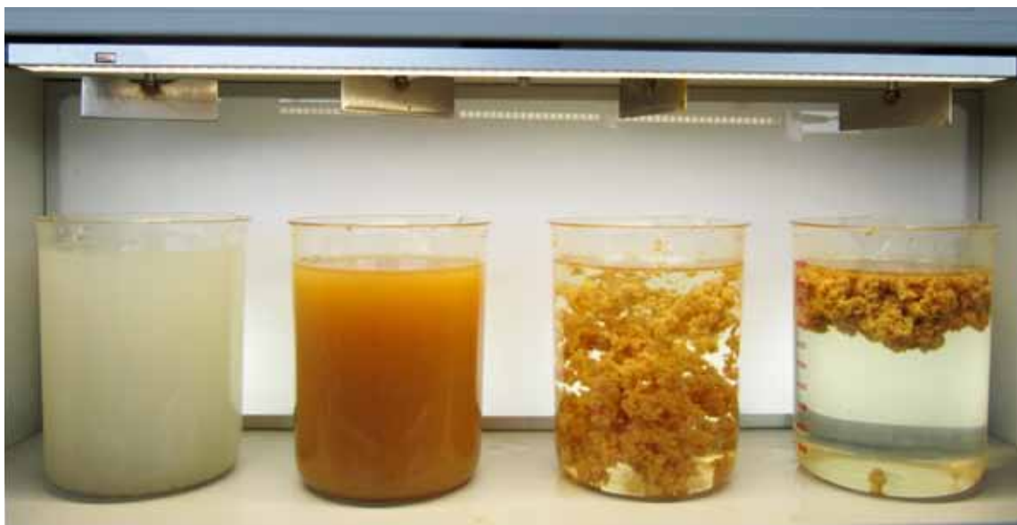
Abb. 5: Laborversuche zur Emulsionsspaltung in Praxis und Theorie, v. links: Rohabwasser Molkerei, Abwasser nach Emulsionsspaltung, Koagulation, Phasentrennung fest/flüssig
